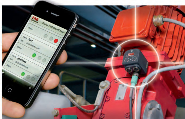
Zustandsüberwachung mit einem FAG SmartCheck. SmartPhone als Alarmempfänger.
